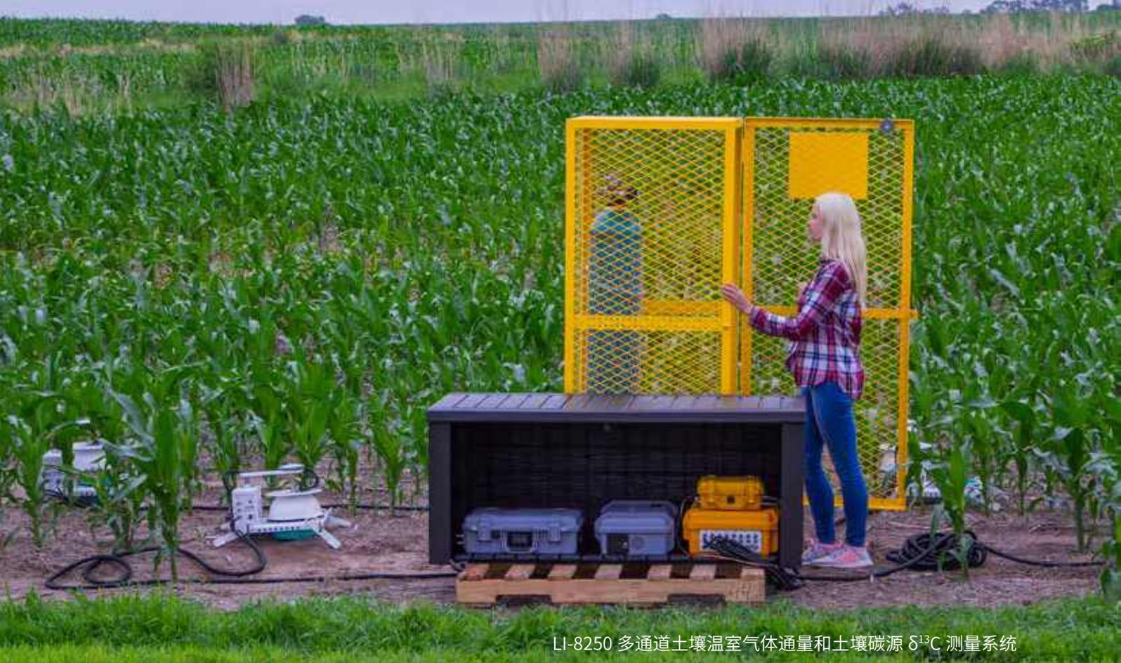
LI-8250 多通道土壤温室气体通量和土壤碳源  $\delta^{13}\text{C}$  测量系统
